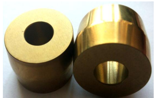
Рис. 8. Робочі елементи деформуючої протяжки з покриттям TiN.
