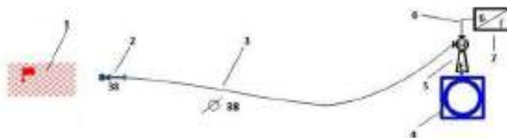
Рисунок 1. 1-умовна зовнішня пожежа; 2-пожежний ствол; 3- рукав(шланг); 4-колодязь; 5-дренажний насос; 6-електричний кабель; 7-бензиновий генератор
