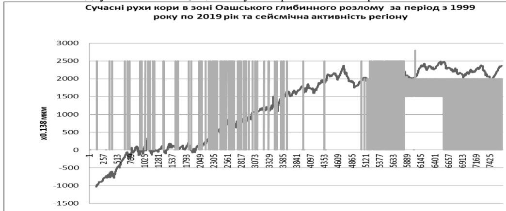
Рис. 1. Сучасні рухи кори в зоні Оашського глибинного розлому за період з 1999 року по 2019 рік( крива чорного кольору) та сейсмічна активність Закарпатського внутрішнього прогину( крива сірого кольору).
