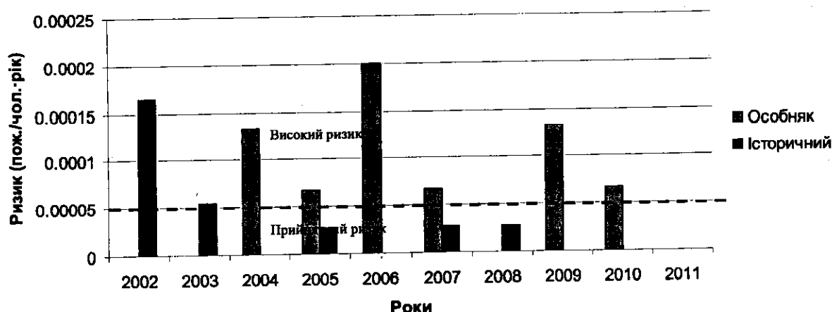
Рисунок 2 – Пожежний ризик зіткнутися з пожежею у житловому будинку (особняк, історичний) з причини порушення правил пожежної безпеки при влаштуванні та експлуатації систем опалення у Личаківському районі за період 2002-2011 рр.
