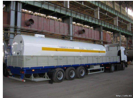
Рис. 7.21. Горизонтальні резервуари для зберігання і транспортування рідких амонійних добрив
