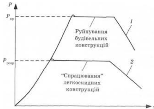
Рис. 5. 15. Графік зміни тиску в приміщенні у разі вибуху: 1 - у приміщенні без легкоскидних конструкцій; 2 - у приміщенні з легкоскидними конструкціями.
