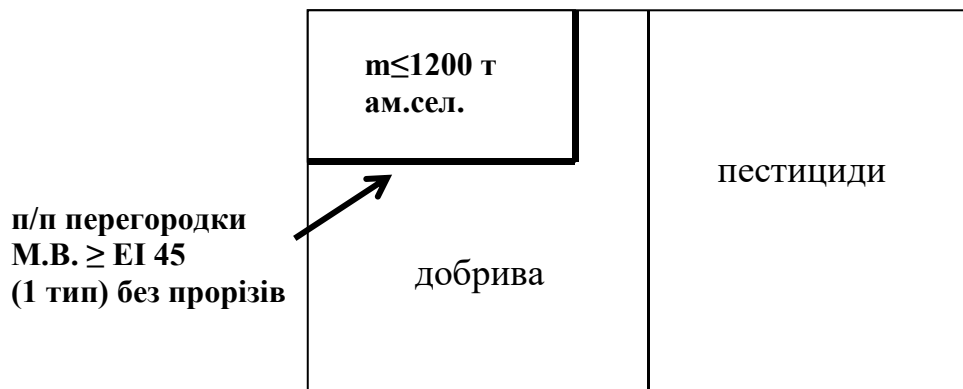
Рис. 7.14. Вимоги до розміщення амонійної селітри в загальному складі
