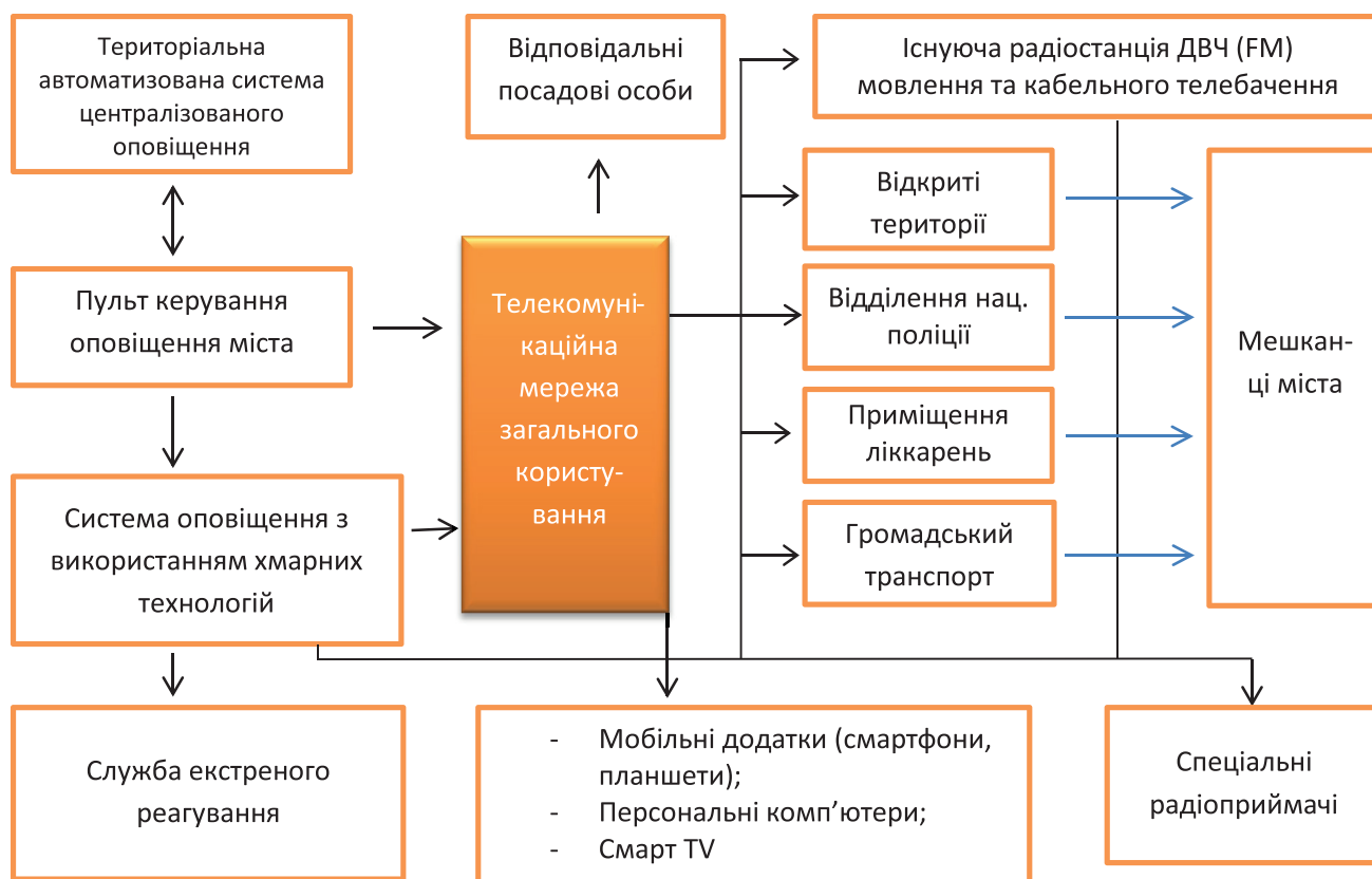
Рис. 2. Схема автоматизованої системи оповіщення міста
